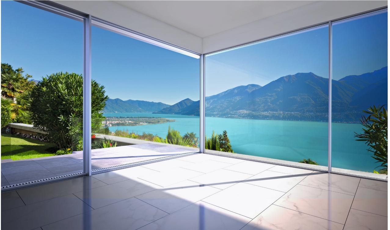
Weitsichtige Architekturideen verlangen nach immer filigraneren und kaum wahrnehmbaren Trägermaterialien und Profilen. Speziell im Wohnbereich liegt der Bautrend bei grossformatigen, rahmenlosen Schiebefenstern. Metallbau Bühlmann bietet dafür ein neues System mit Flügelgewichten bis 750 kg an.
